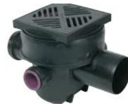
Abb. 8 Bodeneinlauf mit integrierten mechanischen Rückstauverschluss – nur für fäkalienfreies Abwasser zulässig
