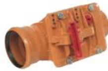
Abb. 7 Mechanischer Rückstauverschluss mit zwei selbstständigen Verschlüssen – nur für fäkalienfreies Abwasser zulässig
